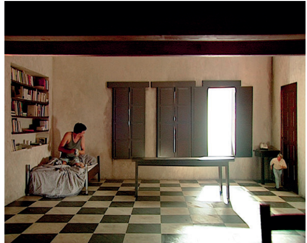
Perspectivische gebouwd decor. In werkelijkheid links 2,5 m hoog en rechts 8 m! Daardoor lijken mensen te krimpen.
